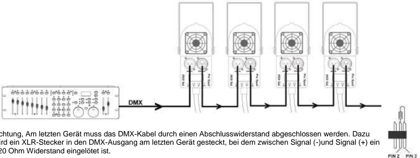
Achtung, Am letzten Gerät muss das DMX-Kabel durch einen Abschlusswiderstand abgeschlossen werden. Dazu wird ein XLR-Stecker in den DMX-Ausgang am letzten Gerät gesteckt, bei dem zwischen Signal (-) und Signal (+) ein 120 Ohm Widerstand eingelötet ist.
