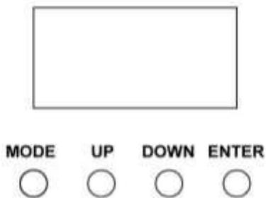
Het bedieningspaneel biedt verschillende mogelijkheden zoals: eenvoudige invoeren van het startadres, voorgeprogrammeerde programma selecteren of een reset. Het hoofdmenu wordt geopend door op de **Mode**-toets, blader door het submenu door **Up** of **Down**-toets.
