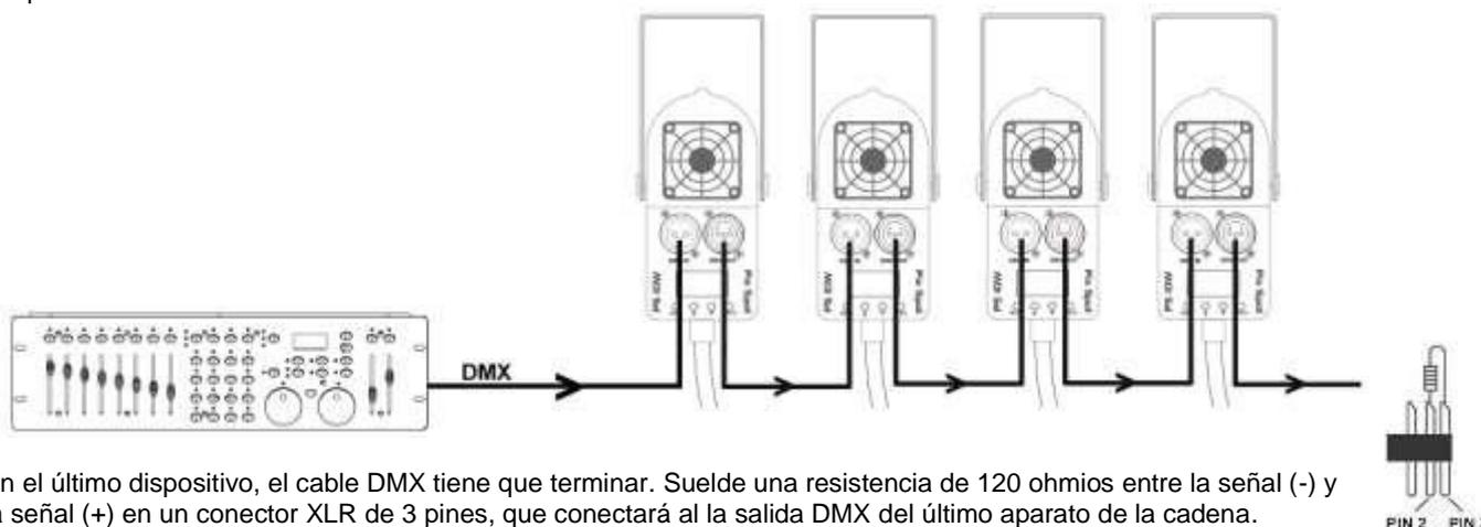
En el último dispositivo, el cable DMX tiene que terminar. Suelde una resistencia de 120 ohmios entre la señal (-) y la señal (+) en un conector XLR de 3 pines, que conectará a la salida DMX del último aparato de la cadena.
