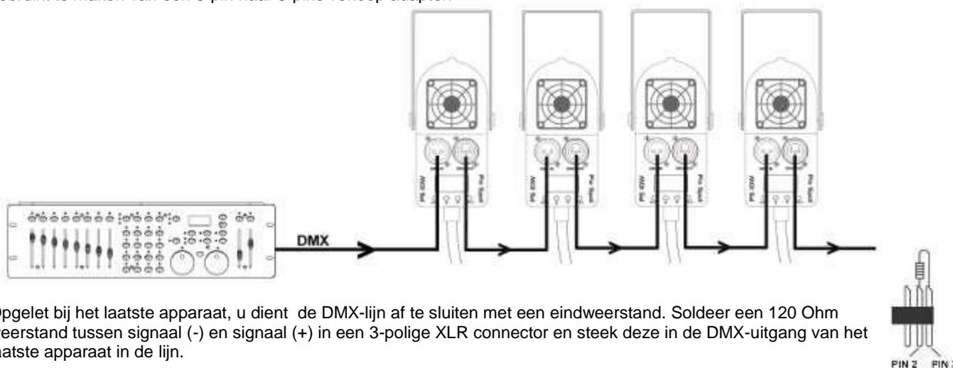
Opgelet bij het laatste apparaat, u dient de DMX-lijn af te sluiten met een eindweerstand. Soldeer een 120 Ohm weerstand tussen signaal (-) en signaal (+) in een 3-polige XLR connector en steek deze in de DMX-uitgang van het laatste apparaat in de lijn.
