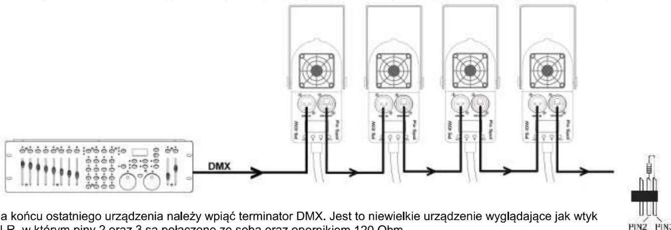
Na końcu ostatniego urządzenia należy wpiąć terminator DMX. Jest to niewielkie urządzenie wyglądające jak wtyk XLR, w którym piny 2 oraz 3 są połączone ze sobą oraz opornikiem 120 Ohm.
