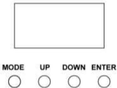
Le panneau de commande vous permet d'effectuer différents réglages : réglage de l'adresse de démarrage, gestion d'un programme pré-programmé, lancer un Reset. Le menu principal est accessible en appuyant sur la touche **Mode**, vous pouvez naviguer dans le sous-menu avec la touche **Up** ou **Down**.
