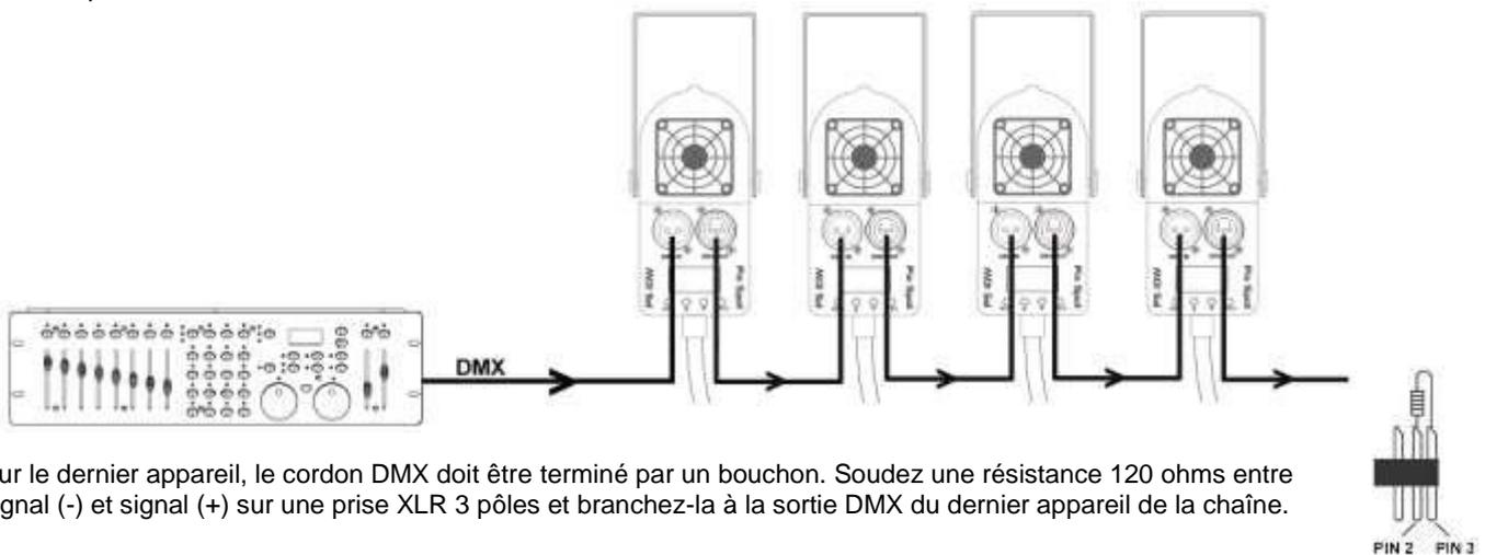
Sur le dernier appareil, le cordon DMX doit être terminé par un bouchon. Soudez une résistance 120 ohms entre signal (-) et signal (+) sur une prise XLR 3 pôles et branchez-la à la sortie DMX du dernier appareil de la chaîne.
