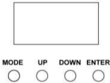
Die Konsole bietet verschiedene Funktionen wie: einfache Eingabe der Startadresse, wählen Sie Preset-Programm oder ein Reset. Das Hauptmenü wird durch Drücken der **Mode**-Taste aufgerufen, blättern Sie durch die Untermenüs durch **Up** oder **Down**-Taste.
